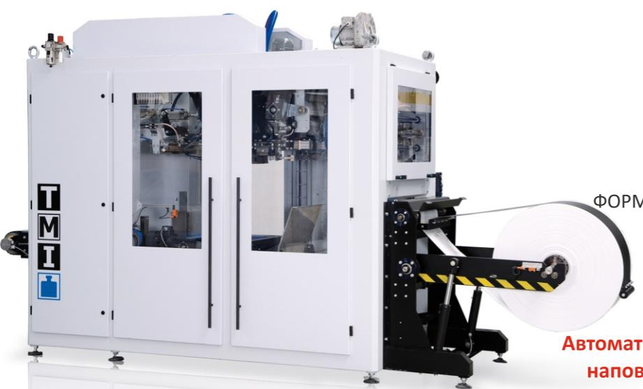
Автоматична машина для формування, наповнення та закриття пакетів з рулону плоскої фольги, підходить для упаковки переважно гранульовані продукти.
