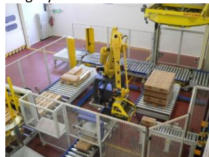
Rys 5. Robot P4 układający dwa rodzaje produktów na dwóch paletach jednocześnie.
