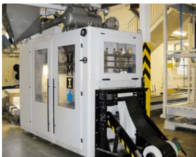
Stacja pakowania FFS model ILEBAG H z systemem dozowania i ważenia opartym na technologii utraty masy
