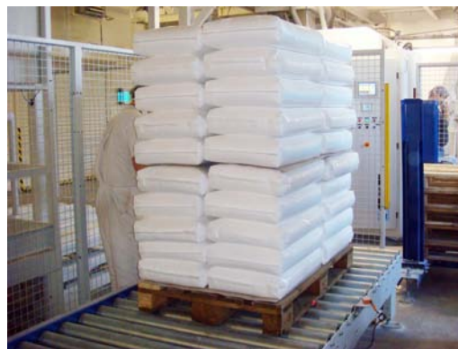
Jedna z pierwszych ułożonych palet. Przekładka pomiędzy warstwami poprawia stabilność ładunku
